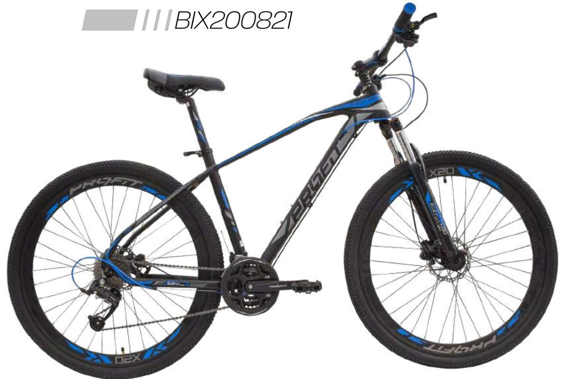
MARCO EN ALUMINIO CON CABLEADO INTERNO, 9 VELOCIDADES, FRENO DE DISCO HIDRÁULICO, TENEDOR BLOQUEO MECÁNICO, TRIPLEPLATO
